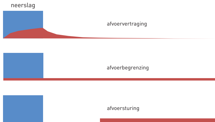
Afbeelding 6 - Karakteristieke verschillen in typen dakafvoer
